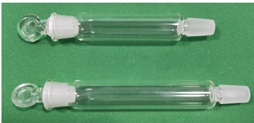
阴极室（电解电极）干燥管（上）和阳极室（池瓶）干燥管（下）
