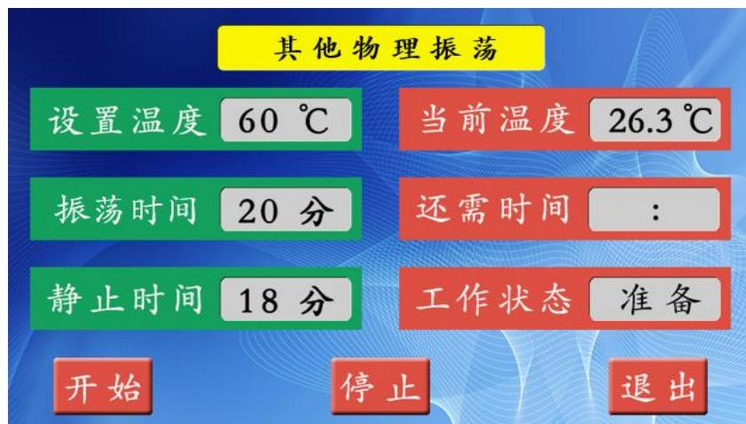
可根据使用要求任意设定温度、振荡时间与静止时间；试验在进行中，按“停止”键，仪器会停止升温、振荡、恒温。按“退出”键，即退出当前界面返回开机主界面。
