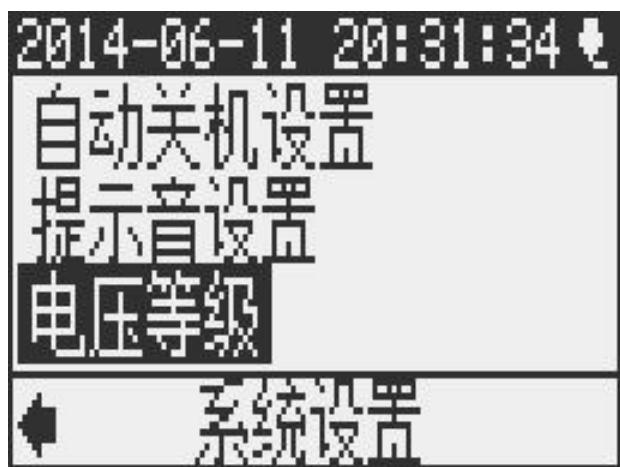
14. 在“**系统设置**”界面，按【▼】箭头键向下移动光标到“**电压等级**”子菜单第五项，按【OK】键进入。
