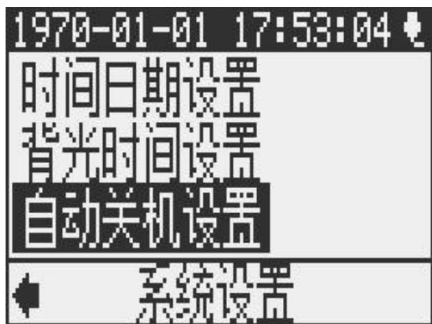
7. 在“系统设置”界面，按【▼】箭头键向下移动光标到“自动关机设置”子菜单第三项，按【OK】键进入。
