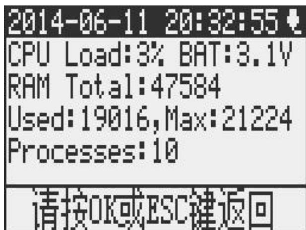
18. 在“系统设置”界面，按【▼】箭头键向下移动光标到“系统状态”子菜单第六项，按【OK】键，显示当前系统的状态，按【OK】或【ESC】键返回“系统设置”界面。
