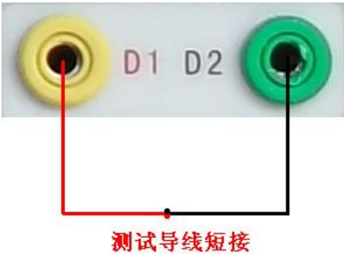
图 22，导线阻值清零接线图
