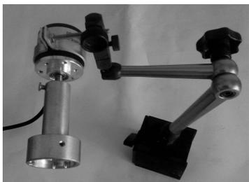
(1)、如密封式 VS1、VD4 开关，安装在开关两侧拐臂（主轴），把两侧白色密封盖拿掉，可看见梅花状的主轴，把专用接头套上即可，安装时保持水平状，再用万向支架固定。
