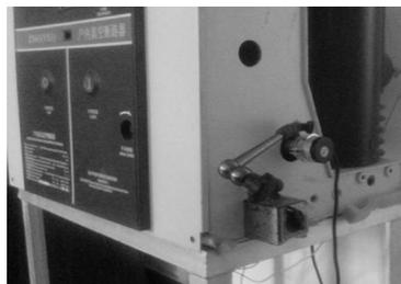
角度测速安装示意图
